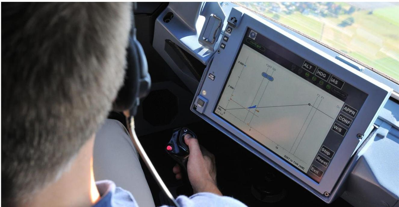
Abbildung 8: Anzeige des Pilotenassistenzsystems LNAS<sup>19</sup>
